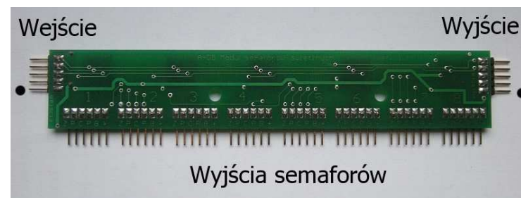
Fot. 2 Widok płytki modułu semaforów
